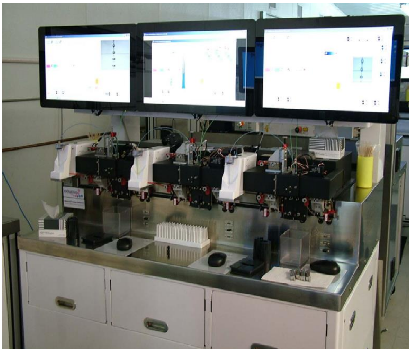
Figura 6: Citómetro Genesis III™ para sexado espermático (42)
